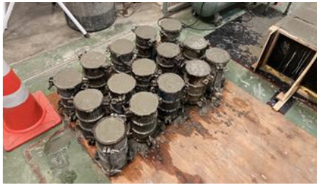
รูปที่ 1 การเก็บตัวอย่างก้อนคอนกรีต
